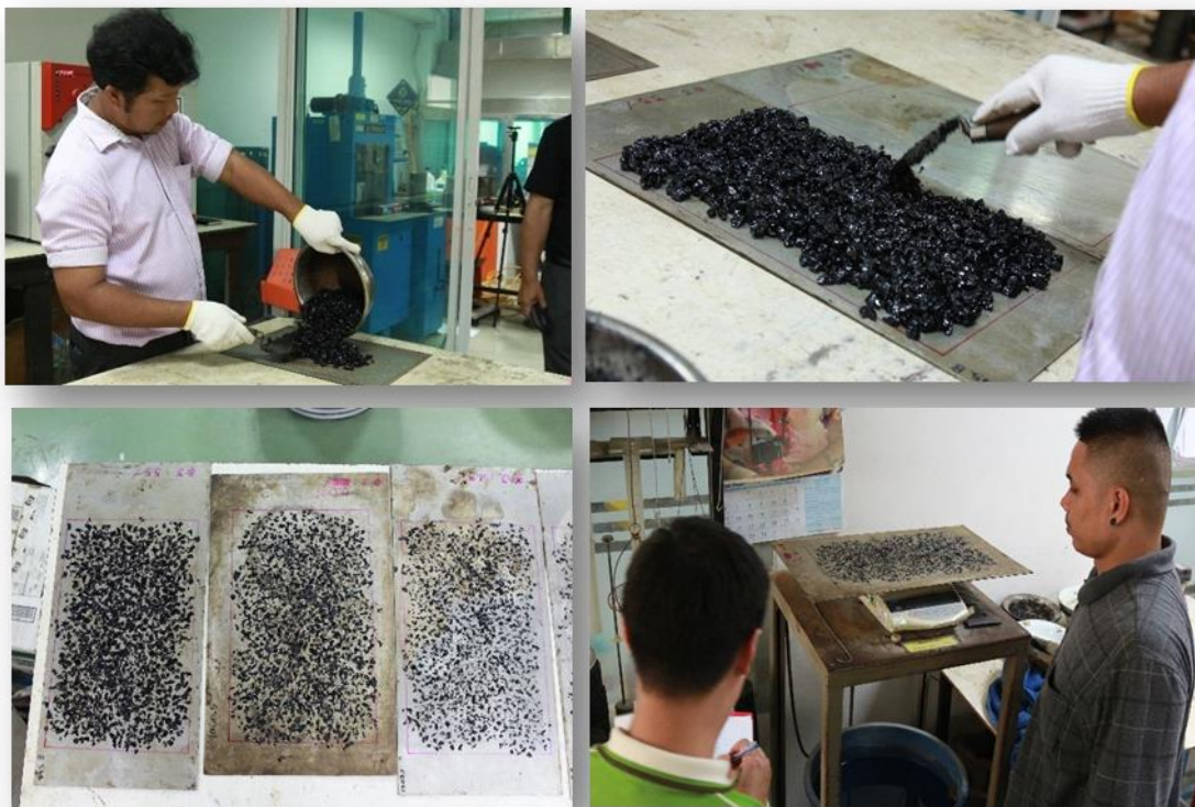
รูปที่ 5 แสดงการหาปริมาณแอสฟัลต์ที่เหมาะสมโดยวิธี Flow Down
